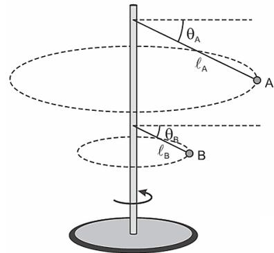
A e B giram em sincronia com a haste, com velocidades escalares constantes  $v_A$  e  $v_B$  e fazem com a direção horizontal ângulos  $\theta_A$  e  $\theta_B$  respectivamente. Considerando  $\ell_A = 4\ell_B$  a razão  $v_A/v_B$  em função de  $\theta_A$  e  $\theta_B$ , é igual a:
